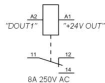
Hinweise: Die maximale Belastbarkeit am Relais/CPU beträgt 24V - 1A. Falls Sie höhere Spannungen/Ströme schalten wollen nutzen Sie das externe Relais.
