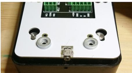
1) Im Auslieferungszustand ist die Sicherungsschraube eingedreht. Der Leser ist NICHT in die Montageplatte eingehängt.
