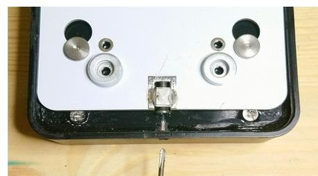
2) Nach der Befestigung der Montageplatte am Ballautomaten oder der Wand den Leser einhängen.
