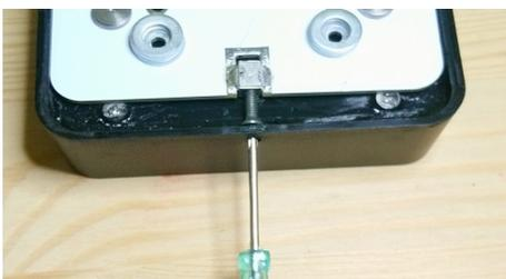
3) Die Sicherungsschraube mit einem kleinen Schraubendreher durch das Loch im Gehäuse nach UNTEN drehen.
