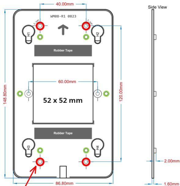
Nur die rot markierten Befestigungslöcher 3 cm links und rechts sowie 6 cm oberhalb und unterhalb der Mitte
